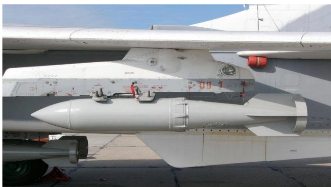
Рисунок 11.24 Бетонобойная авиационная бомба БЕТАБ-500
